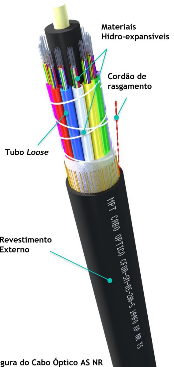
Figura do Cabo Óptico AS NR
